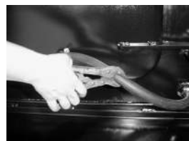
Serrage du tuyau
