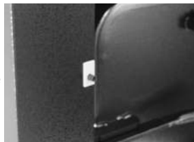
Interrupteur automatique du ventilateur
